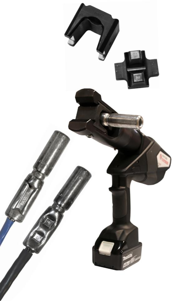
Sistema exclusivo para engaste de aluminio en el sistema 1300. El sistema se ha diseñado para aplicaciones de baja tensión (1 kV) y está adaptado para cables cubiertos de tierra. El número de punzones y matrices ha disminuido de los 21x anteriores (incluido el redondeo previo) a 3 punzones y 3 matrices para el engaste de hendiduras de conductores de Al redondos y sectoriales en el rango de 50-240 mm<sup>2</sup>.
