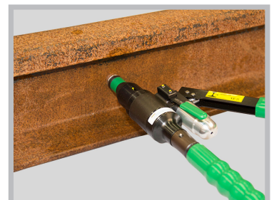
Montageværktøjet placeres på forstykket. Tryk på håndtaget indtil der høres et "klik". Efter tilspænding af samlingen med momentnøglen sidder Railbond fast.
