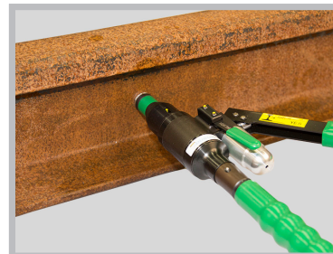
Monteringsverktyget sätts på dess framstycke. Pressa handtaget tills ett "klick" hörs. Efter åtdragning av förbandet med momentnyckeln sitter Railbonden fast.
